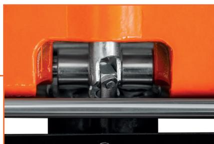
Привод управления клапаном сброса с крданным шарниром
